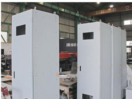
ZAM材の切断加工やプレス、溶接・外枠の組み立て、研磨、塗装までを請け負っています。通常出回っている規格品とは異なり、中に配置する機材や材質、設置場所、耐久性なども鑑みて顧客とともにオリジナルのものを作り上げていく、職人たちによる“ものづくり”の会社です。
